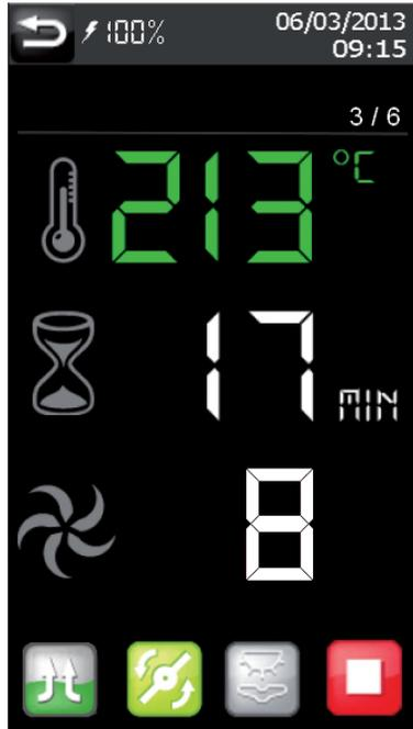
Регулятор скорости : Позволяет уменьшить до 40% скорость вращения турбины. Значения, указанные ниже, являются ориентировочными и могут изменяться от одной печи к другой.
