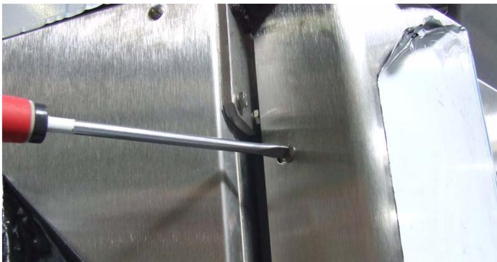
1) Для замены лампочек освещения, снимите боковую панель (со стороны петель двери).
